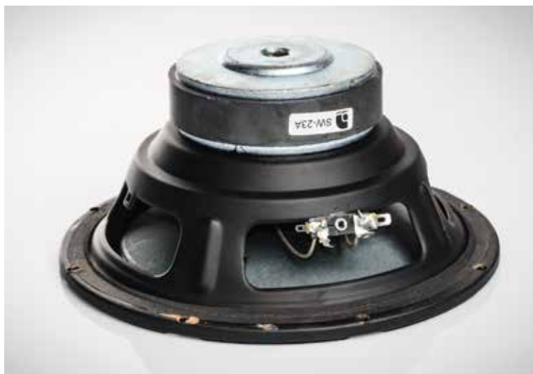
8-calowy (200 mm) głośnik basowy ma papierową membranę. Otwór wentylujący w magnesie zwiększa obciążalność mocową.
