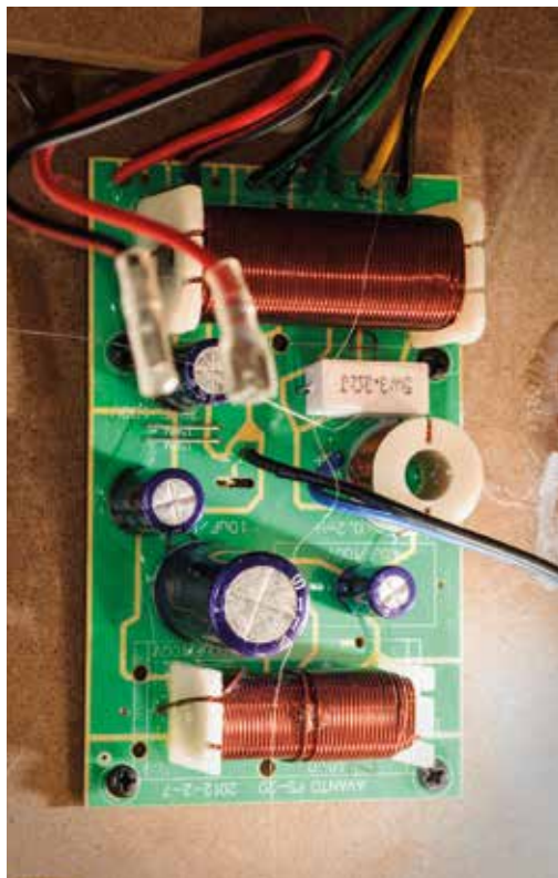
Zwrotnica (a właściwie jej część średnio-wysokotonowa) kolumn frontowych FS-20. Sensowne elementy, poprawny montaż. Do woofera na bocznej ścianie mamy dostęp po zdjęciu maskownicy.
